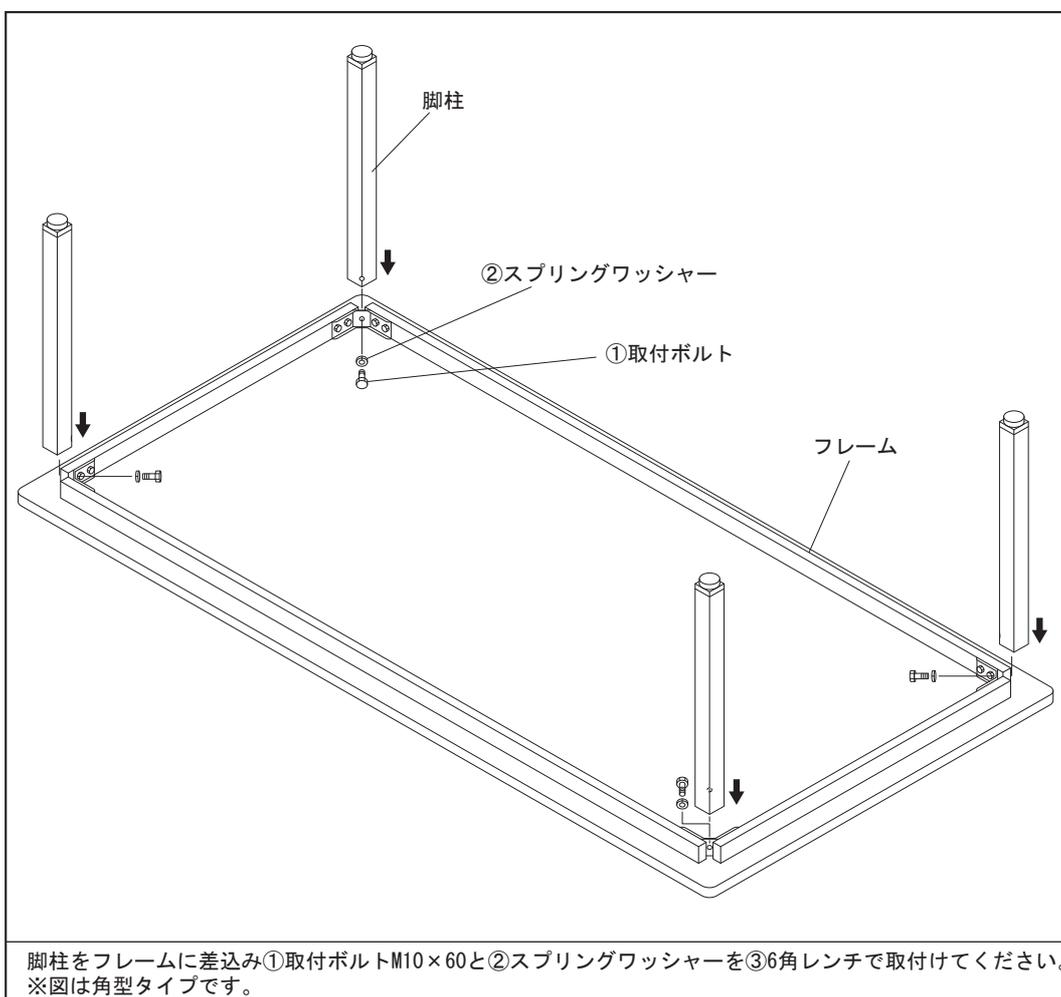
脚柱をフレームに差込み①取付ボルトM10×60と②スプリングワッシャーを③六角レンチで取付けてください。
